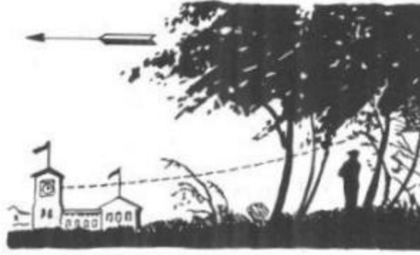
Figura 109. La influencia del viento contrario en la propagación del sonido
