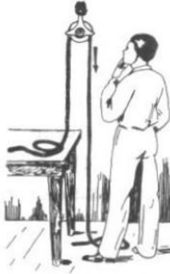
Explicación evidente de cómo funciona el sifón.
